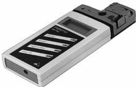
Endereçador As-i: Utilizado para determinar o endereço dos slaves em uma rede As-i, independente do fabricante.
