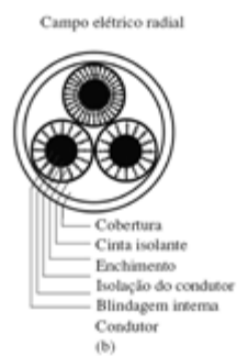
Figura 5.15 • Blindagem sobre a isolamento
