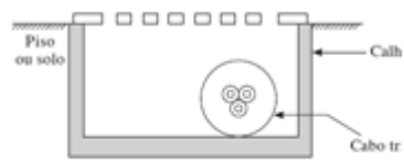
Figura 5.31 • Corte de uma canaleta (com tampa) ventilada
