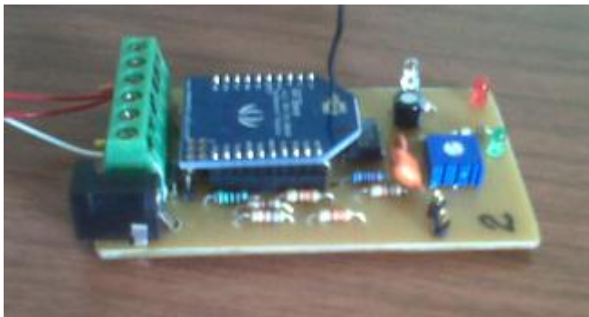
Figura 2 – Circuito sensor utilizado para aquisição de dados.
