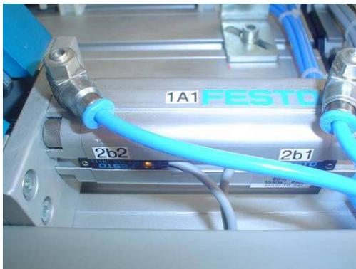
Podemos verificar que quando o atuador está recuado o sistema está em sua posição inicial, sendo que o funcionamento consiste no avanço do atuador para que seja executada a separação da mola.
