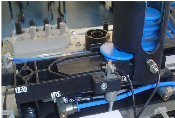
Podemos verificar que quando o atuador está avançado o sistema está em sua posição inicial, sendo que o funcionamento consiste no retorno do atuador para que seja executada a separação da peça.
