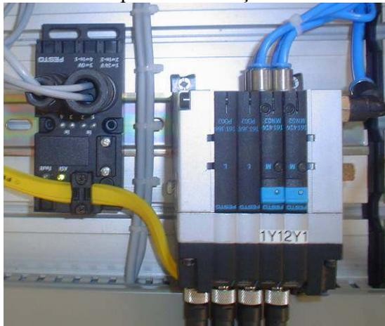
Módulos de IN/OUT da estação de montagem
