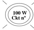
Ponto de luz incandescente ou fluorecente eletrônica de 100 W, embutido no teto.
