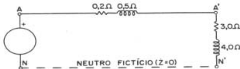
(b) Circuito monofásico equivalente
