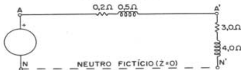
(b) Circuito monofásico equivalente
