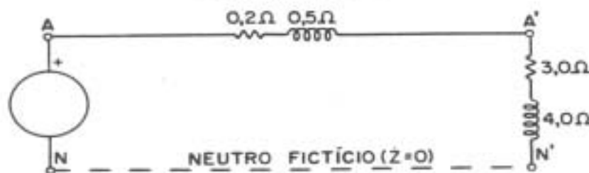
(b) Circuito monofásico equivalente
